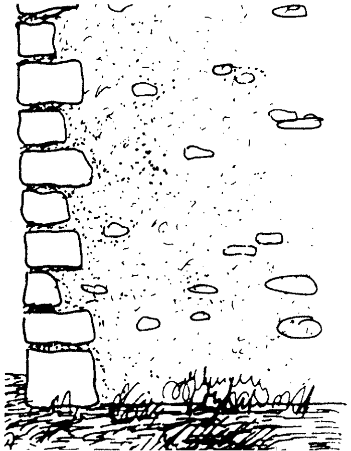
Enduit à “pierre vue” : l'enduit ne laisse apparaître que les pierres d'angle et les pierres saillantes du mur.
