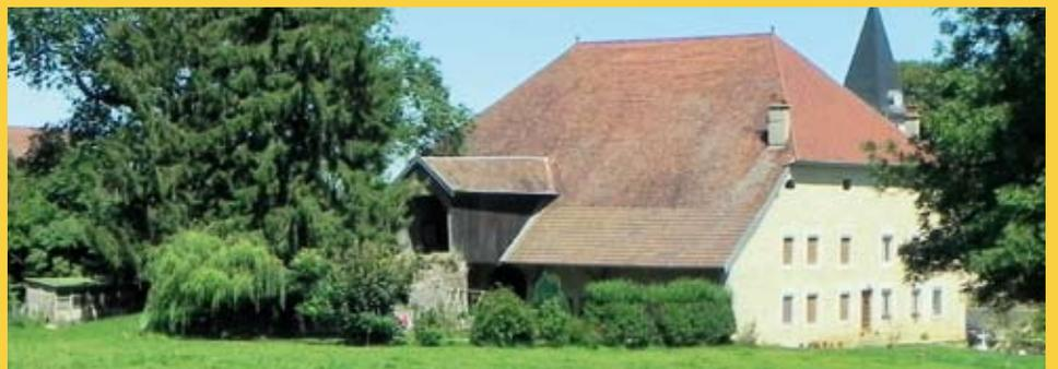
Une structure en bois, qui intègre la porte de grange, est construite en avancée et perpendiculairement au volume de la ferme.
