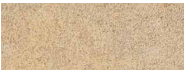
La pigmentation des sables permet d'obtenir des teintes plus ou moins soutenues et la granulométrie une finition plus ou moins régulière.
